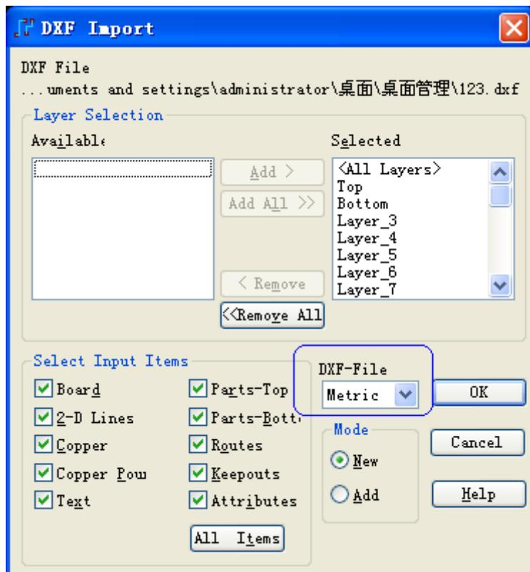
二、这种方法最简单，将 DXF 原文档放大 39.37 倍再导到 POWERPCB 中去即可：
